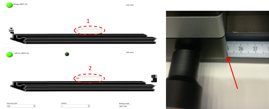
Figure 5: Angiv positionen af prøveholderen (1) og detektoren (2). Positionen skal angives i mm, og måles på bagsiden.
